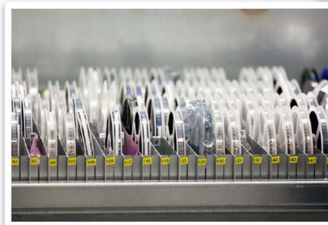
节约空间并提升效率：在自动存储系统中使用带有用户ID的物料盘。
